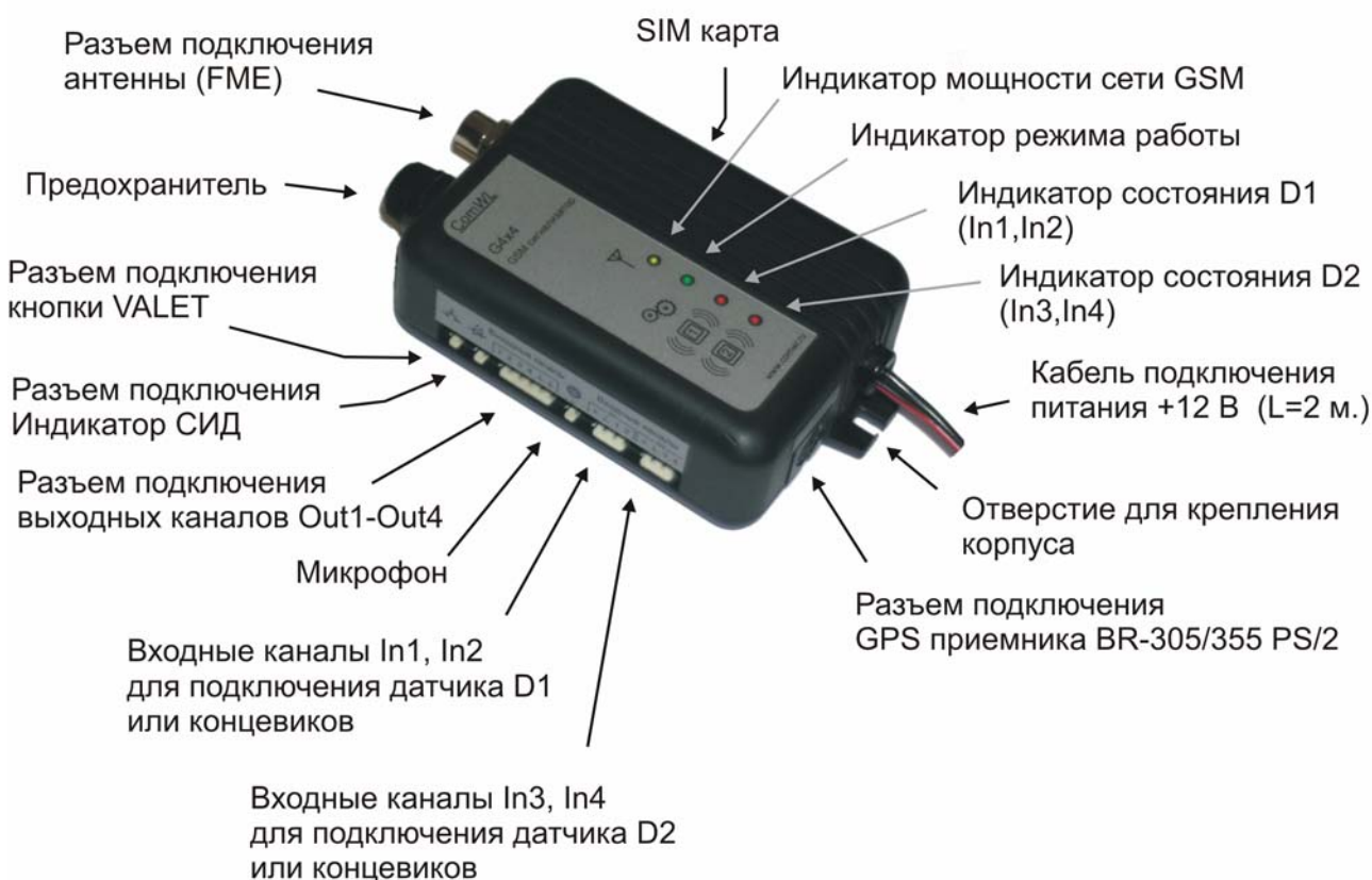
Рис. 1 Назначение разъемов и индикаторов
