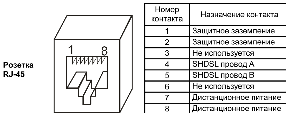
Рис. 7. Назначение контактов порта SHDSL
