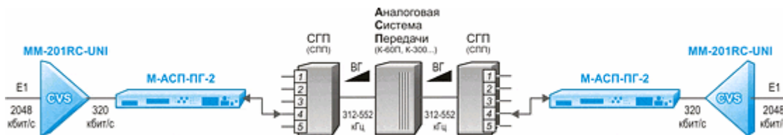
Рис. 4. Передача полного потока E1 по тракту первичной группы АСП со сжатием голосовых каналов
