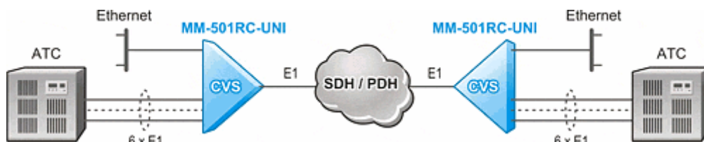
Рис. 3. Передача шести полных потоков E1 и данных Ethernet по одному каналу E1
